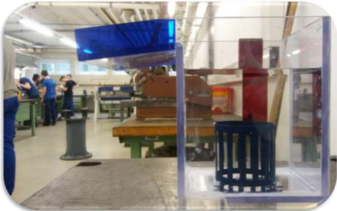
Abbildung 14: Dichtheitsprüfung der Flotationszelle
