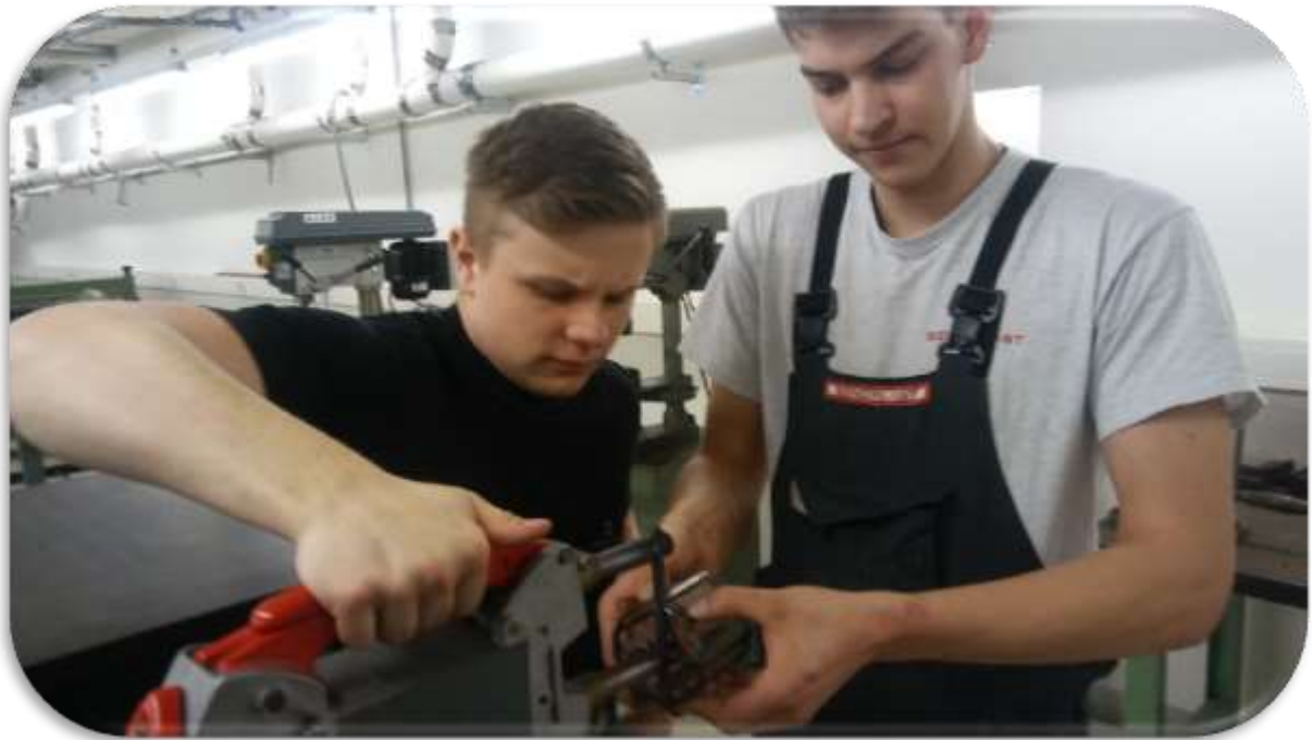
Abbildung 8: Herstellung des Luftverteilers
