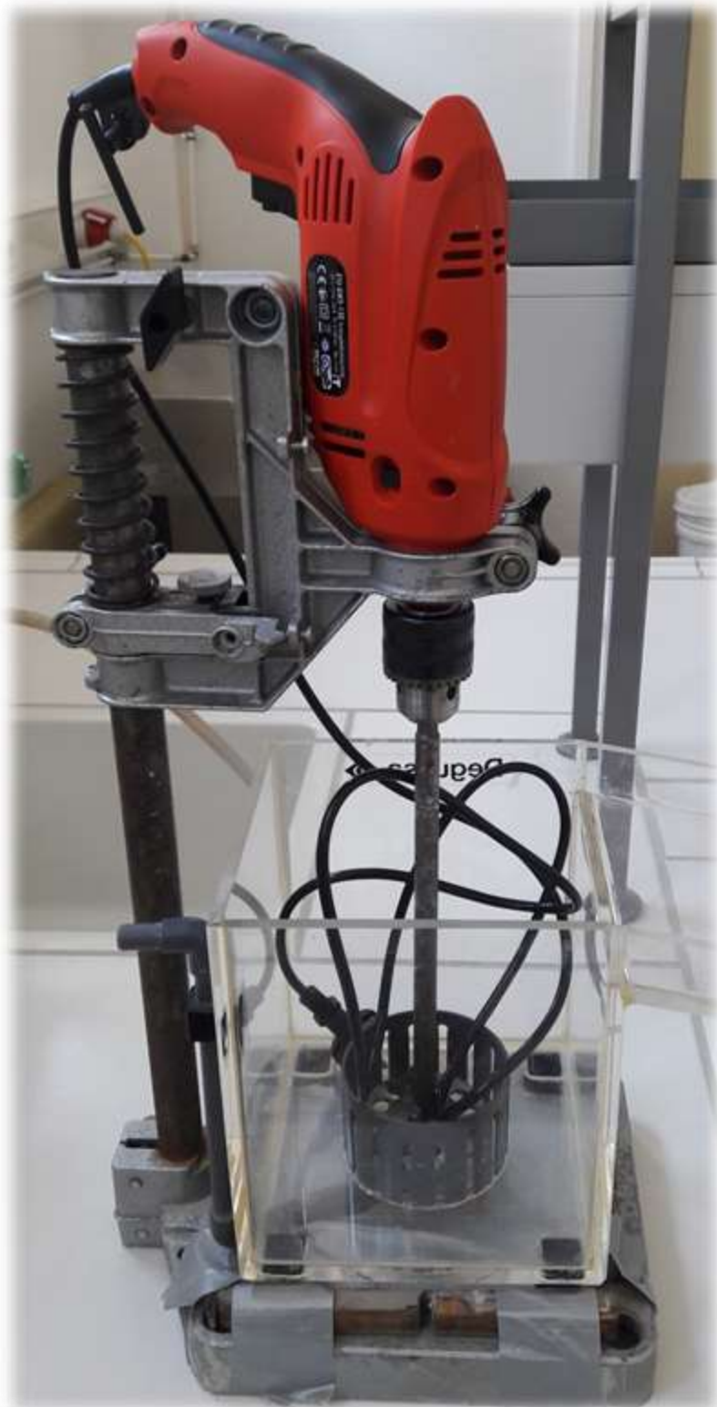
Abbildung 1: Provisorische Flotationszelle vom ABZ Steyrermühl
