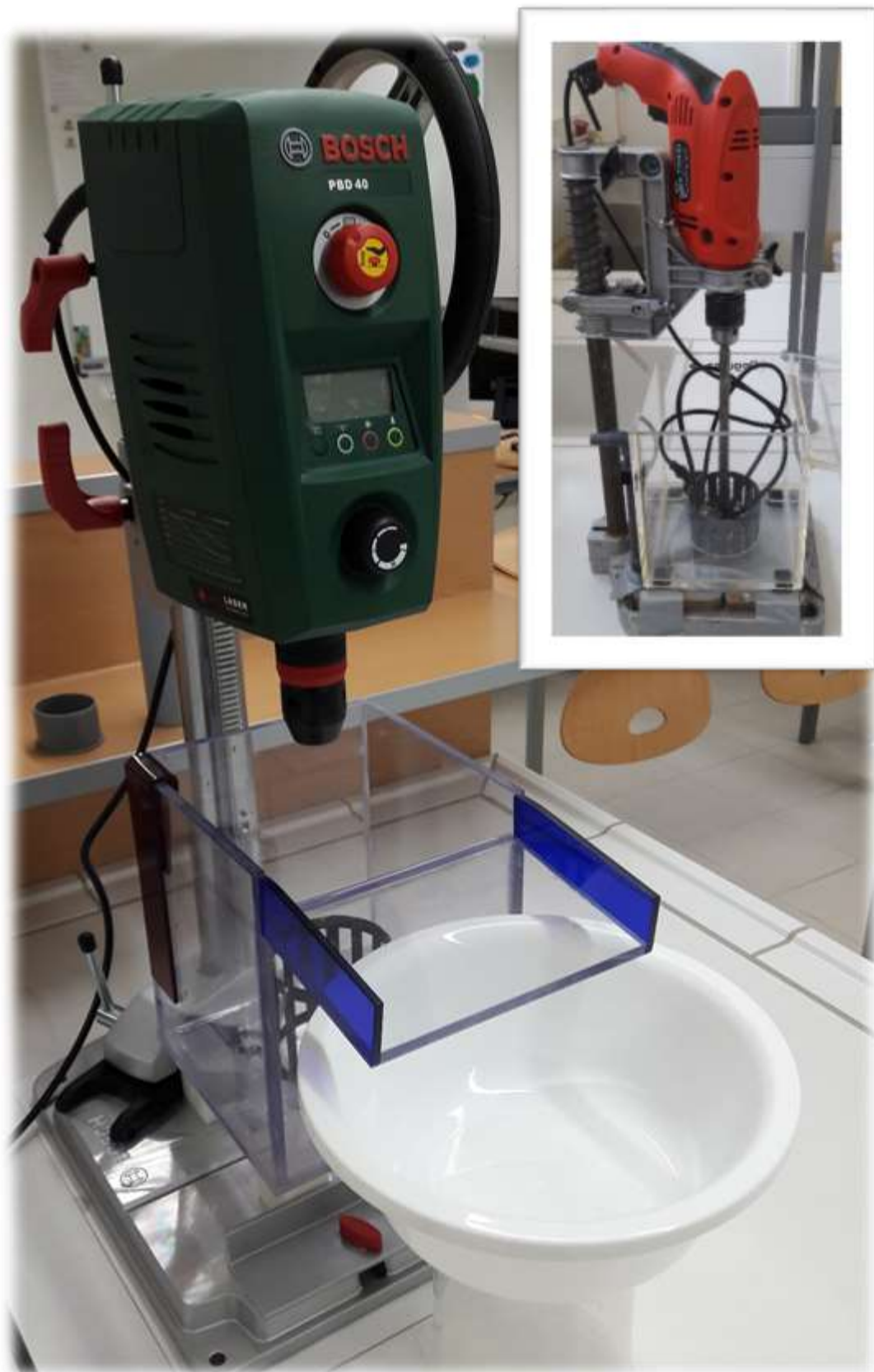
Abbildung 16: Flotationszelle mit Ständerbohrmaschine als Rührwerksaggregat
